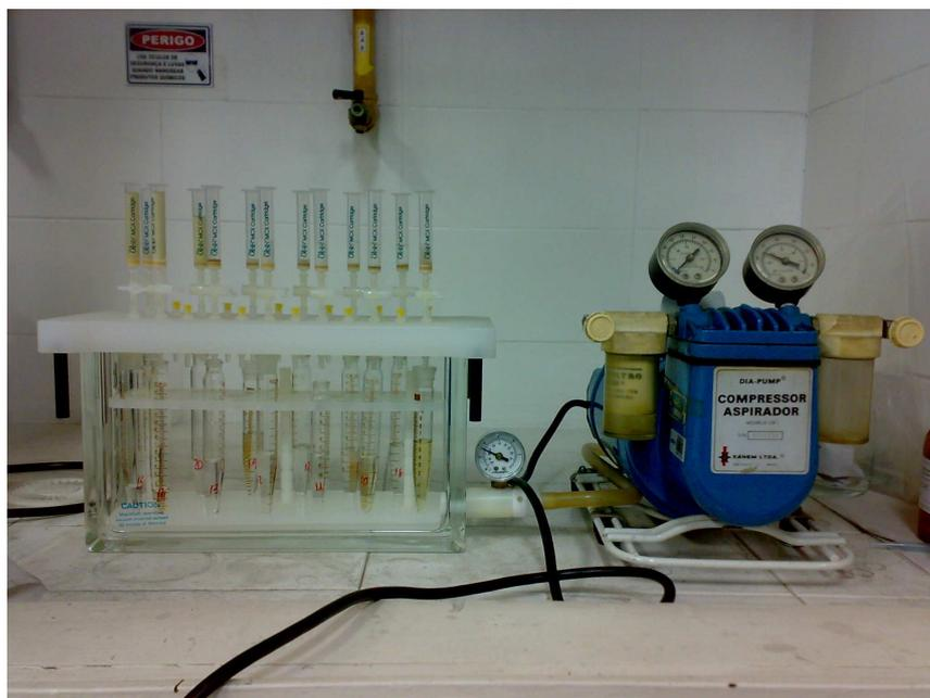
**Figura 11 - Aparelho de extração em fase sólida (marca J.T. Baker)**
