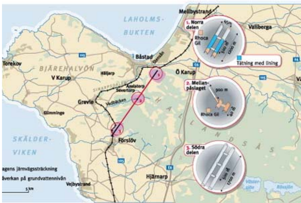
Figura 2: Mapa da rocha Hallandsas e o plano de construção da ferrovia de alta velocidade.
