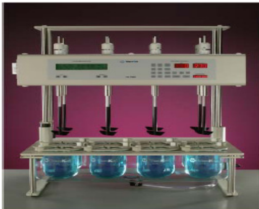
Figura 6 – Aparelho dissolutor com pás (aparato nº 2) (SILVA, 2007).
