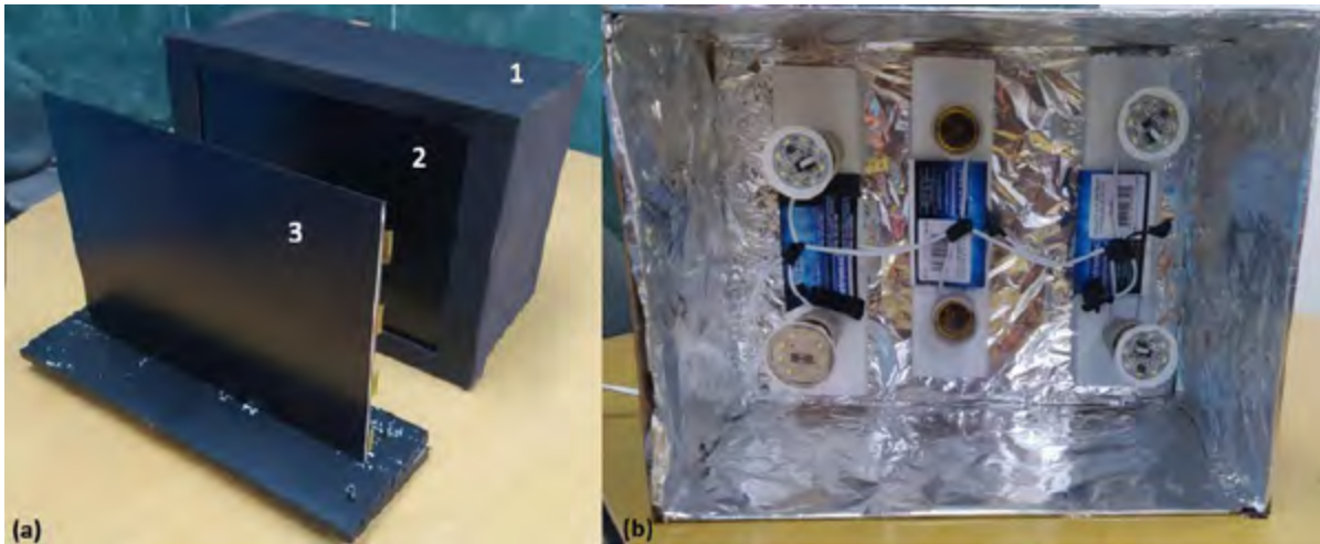
FIGURA 2 - Detalhes da fonte de luz polarizada. Em (a) observa-se a caixa de MDF (1) com primeiro polarizador (2) fixado na tampa e segundo polarizador (2) posicionado em uma base móvel. Em (b) observa-se o posicionamento das lâmpadas no interior da caixa, que foi recoberta com papel alumínio.
