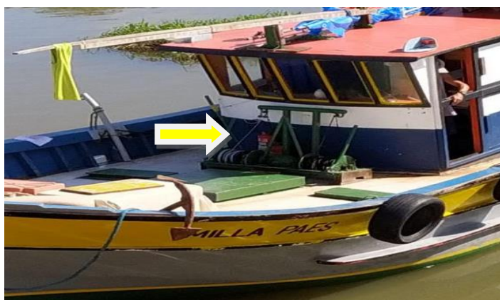
Figura 8: Guincho utilizado para recolher a rede de arrasto
