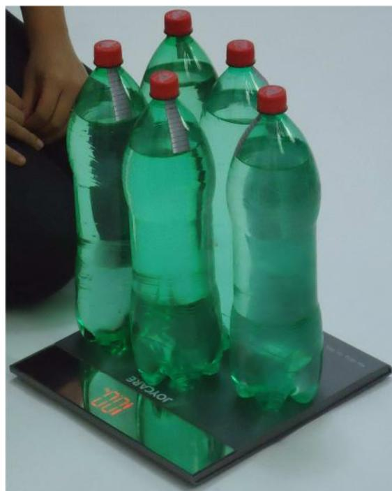
Figura 8: Peso padrão (10kg) utilizado para calibração da balança
