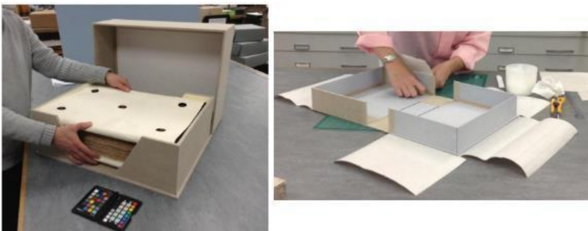
Fig. 49 e 50: Exemplo de Caixa Solander finalizada e em processo de confecção. 196 Fonte: BIBLIOTECA DE OBRAS RARAS DA UNIVERSIDADE DE CAMBRIDGE, 2017.
