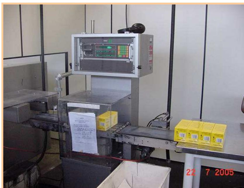
O sistema Vision verificará se a impressão dos cartuchos está de acordo com os padrões pré-definidos, certificando-se se há falta de algum dígito e/ou se houve alguma falha na impressão. Caso haja qualquer desvio de padrão em qualquer estágio, o produto será desprezado por um sistema de rejeição.
