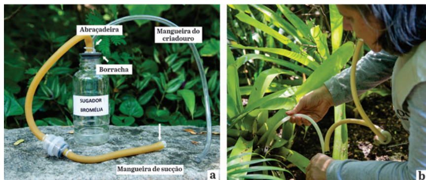
Figura 11: Foto do ‘sugador de água de bromélia’; as setas em (a) indicam a mangueira de látex usada como mangueira de sucção, mangueira de criadouro e os materiais utilizados como abraçadeira e borracha; em (b) a operadora utilizando o sugador de água de bromélia. Fonte: Ricardo Schmidt (IOC/Fiocruz).
