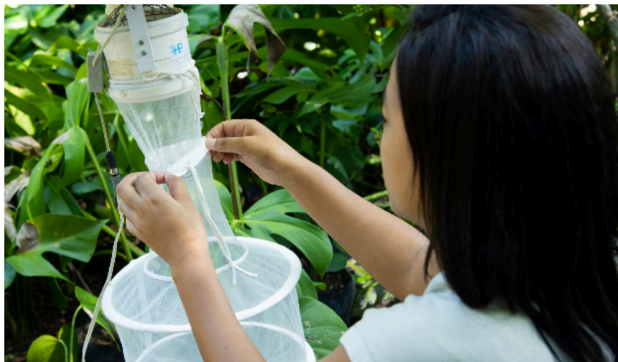
Figura 37: Foto do operador desfazendo o nó do saco coletor da armadilha do tipo CDC da marca HP. Fonte: Ricardo Schmidt (IOC/Fiocruz).
