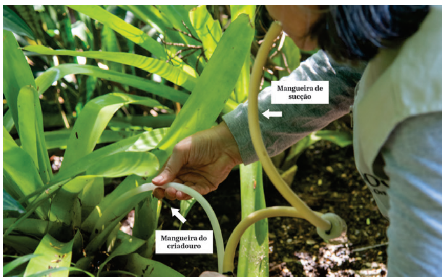
Figura 27: Foto da operadora utilizando o ‘sugador de água de bromélia’, as setas indicam a mangueira no interior da bromélia (axila da bromélia) e a mangueira que vai em direção à boca. Fonte: Ricardo Schmidt (IOC/Fiocruz).
