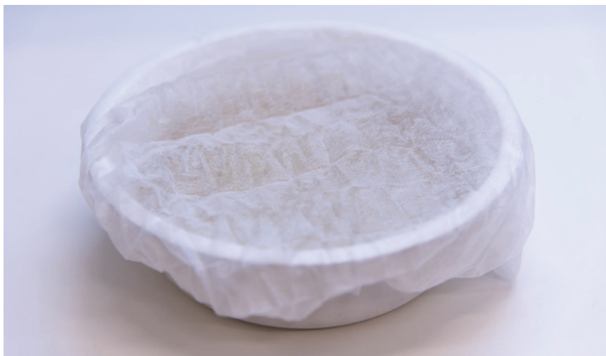
Figura 21: Foto da bacia com “tela de proteção”, neste caso, uma touca descartável. Fonte: Ricardo Schmidt (IOC/Fiocruz).
