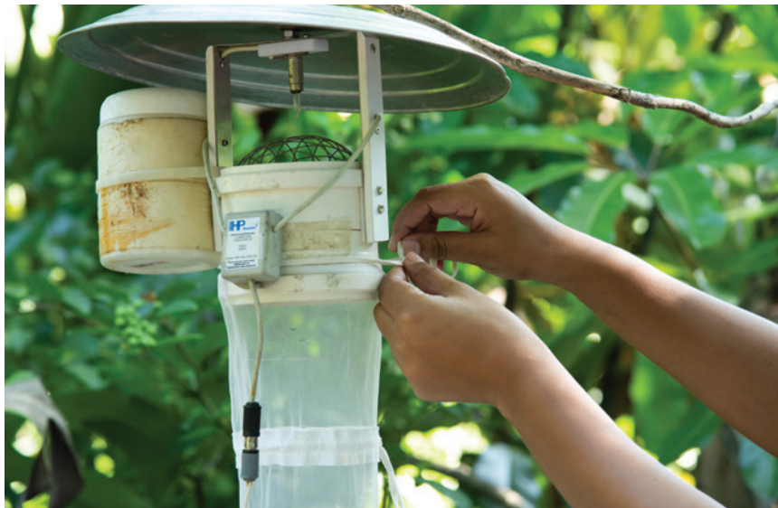
Figura 36: Foto do operador amarrando o saco coletor na armadilha do tipo CDC da marca HP. Fonte: Ricardo Schmidt (IOC/Fiocruz).
