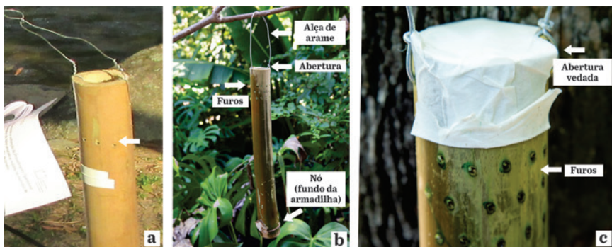
Figura 9: Foto da ‘armadilha de bambu’; em (a) a seta indica uma sugestão de espessura para o furo do bambu; em (b) as setas indicam abertura, furos, a alça de arame galvanizado e o nó do bambu; em (c) as setas indicam uma sugestão de furos e a abertura vedada, como a armadilha deve ser usada. Fonte (a): Mariana Dionizio (CEVAS/Macaé & IOC/Fiocruz); (b e c): Ricardo Schmidt (IOC/Fiocruz).
