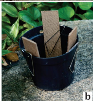
Figura 8: Fotos de ovitrampas; as setas em (a) indicam o vaso de planta utilizado como recipiente preto e o furo lateral, denominado de “ladrão” e em detalhes as partes que compõem uma ovitrampa, as setas indicam a palheta do tipo “Eucatex”, a face rugosa onde as fêmeas fazem a postura e o clipe metalizado que serve para fixar as palhetas; (b) ovitrampa completa montada com as três palhetas para uso silvestre. Fonte (a): Marcelino Rocha (CEVAS/Macaé); (b): Ricardo Schmidt (IOC/Fiocruz).
