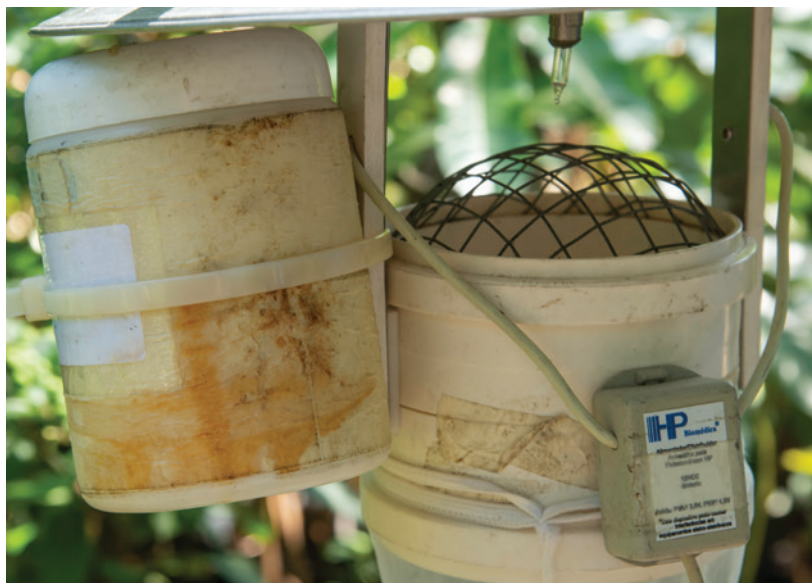
Figura 39: Foto da adaptação do gelo seco (no interior da gaiola, à esquerda na imagem) à armadilha do Tipo CDC da marca HP. Fonte: Ricardo Schmidt (IOC/Fiocruz).
