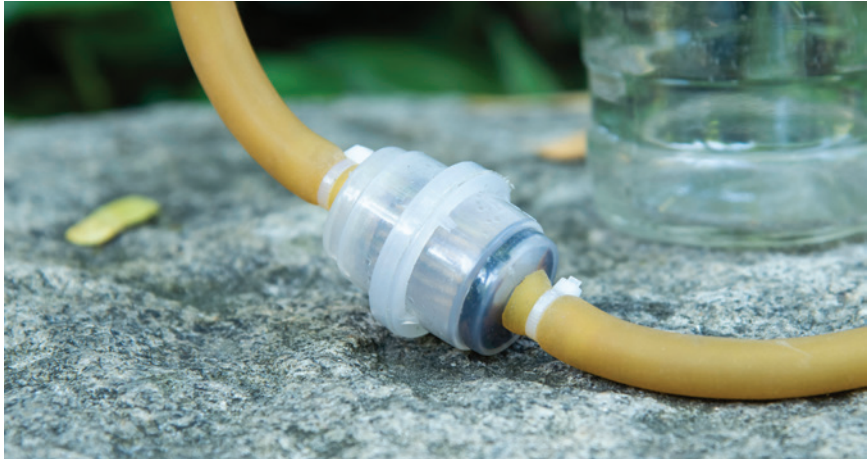
Figura 12: Foto do filtro de combustível de moto universal que pode ser acoplado no ‘sugador de água de bromélia’ para biossegurança do operador. Fonte: Ricardo Schmidt (IOC/Fiocruz).
