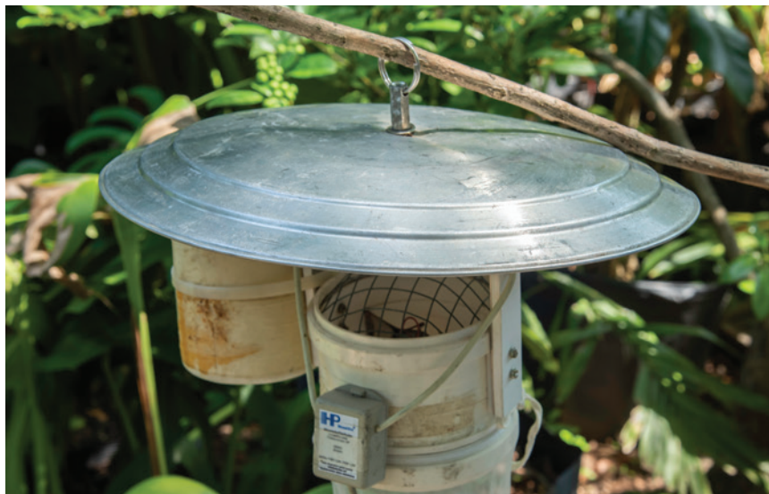
Figura 35: Armadilha do tipo CDC da marca HP com protetor contra a chuva em alumínio. Ricardo Schmidt (IOC/Fiocruz).
