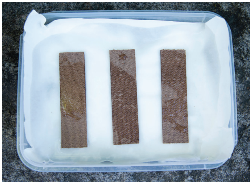
Figura 20: Foto de câmara úmida contendo palhetas. Fonte: Ricardo Schmidt (IOC/Fiocruz).
