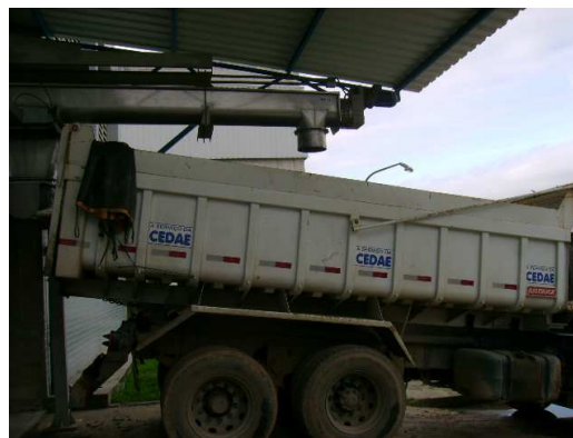
Figura 10.1.3.8. Transporte do lodo tratado
