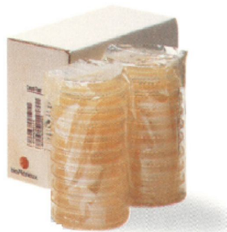
Ilustração 6 - Placas de Contato RODAC, usadas para o monitoramento microbiológico de superfícies em salas limpas
