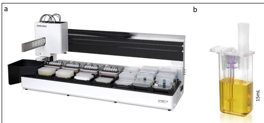
Figura 3.10. Microbiorreator Ambr15 – Sartorius. (a) Estação de cultivo automatizado para células de mamíferos com capacidade para até 48 microbiorreatores. (b) Microbiorreator descartável com volume útil de 10 a 15 mL, presença de impeller , região para entrada de gases e sensor óptico para monitoramento de DO e pH.
