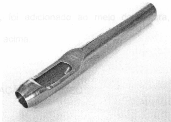
Figura 5. Cortador metálico utilizado para recortar as matrizes 3D de quitosana e colágeno tipo I no diâmetro interno de 8 mm.
