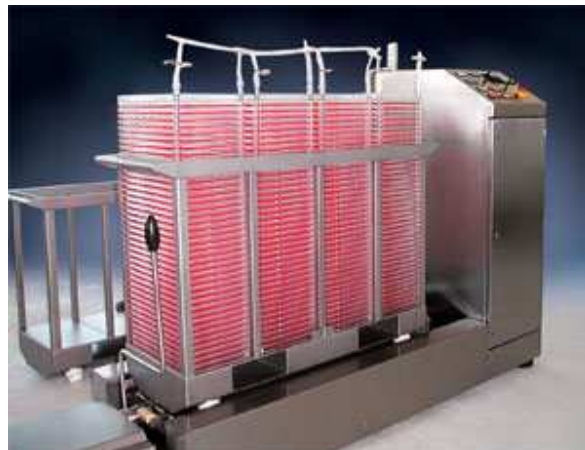
Figura 1.4- Modernas tecnologias de produção de vacinas contra a rubéola aplicam sistemas de produção de células MRC-5 em larga escala. (Cell factory ) http://www.nuncbrand.com/page.aspx?ID=10172#top
