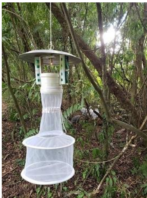
Figura 6 - Armadilha de isca luminosa modelo HP utilizada nas capturas em Santa Cruz do Sul, Rio Grande do Sul, 2020. Fonte: CEVS/SES/RS, 2020.
