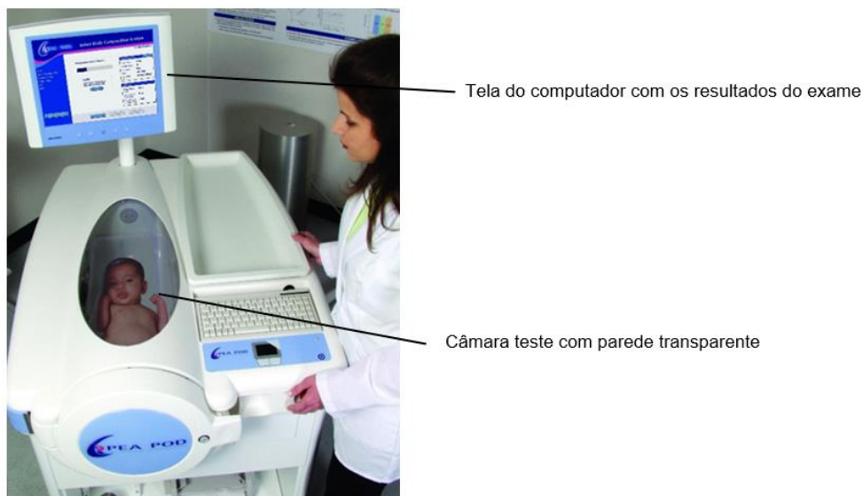
Figura 7. Medição da composição corporal através do PEA-POD (Fonte: Cosmed)
