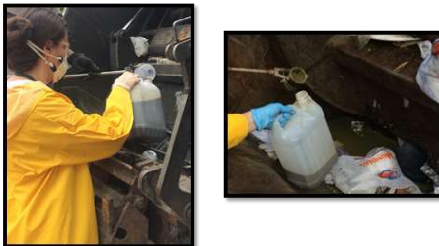
Figura 12: Coleta de lixiviado diretamente da bacia do caminhão de coleta de resíduos sólidos, na Estação de Transferência de Resíduos (ETR=Jacarepaguá).
