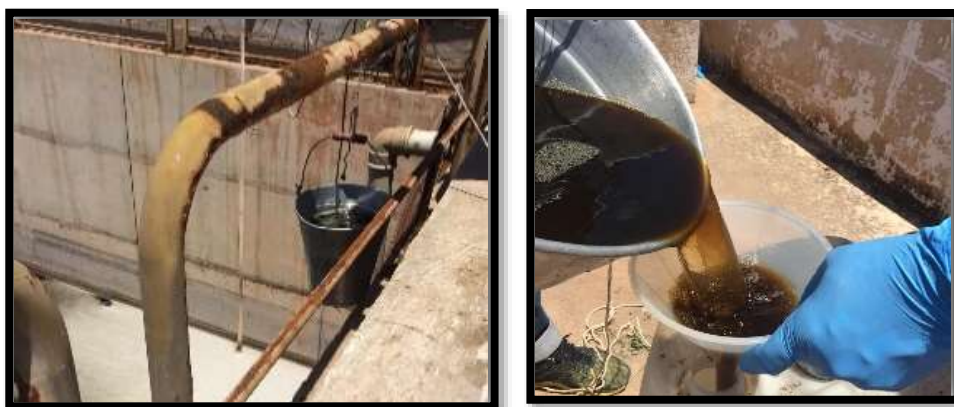
Figura 11: Coleta de lixiviado de aterro sanitário na Central de Tratamento de Resíduos (CTR Rio).
