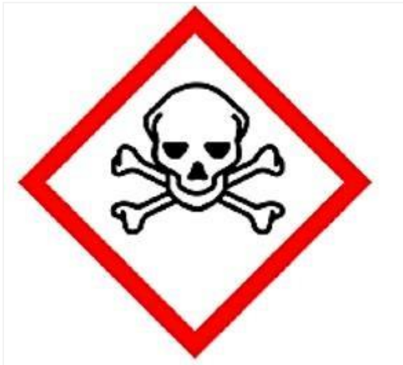
Figura 8 – Símbolo de classificação e rotulagem de produtos químicos perigosos Globally Harmonized System .
