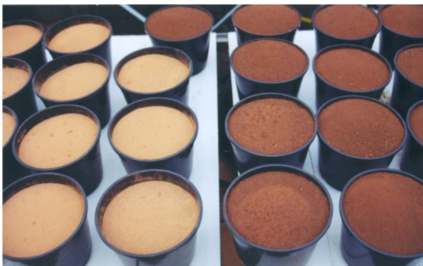
**Figura 3.2. Detalhe dos solos contaminados, à esquerda Latossolo Amarelo e a direita Latossolo Vermelho.**
