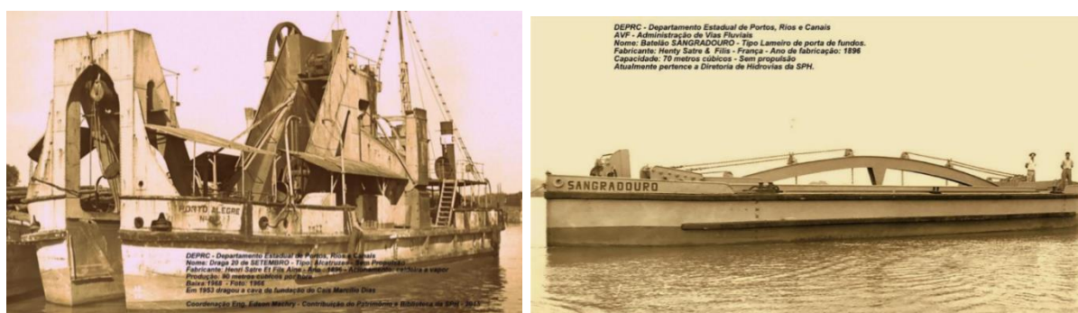
Figura 15: Exemplos de draga de alcatruzes e batelão construídos pela Satre et Fils em 1896.
