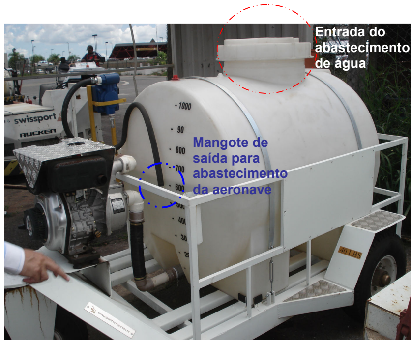
Figura 06 – Foto ilustrativa do veículo de apoio aeroportuário para abastecimento de água das aeronaves (QTA).
