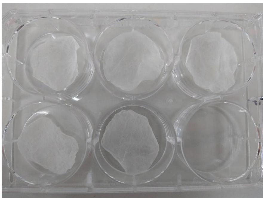
**Figura 11-** Membranas impregnadas com água e secas na estufa a 30 °C overnight.
