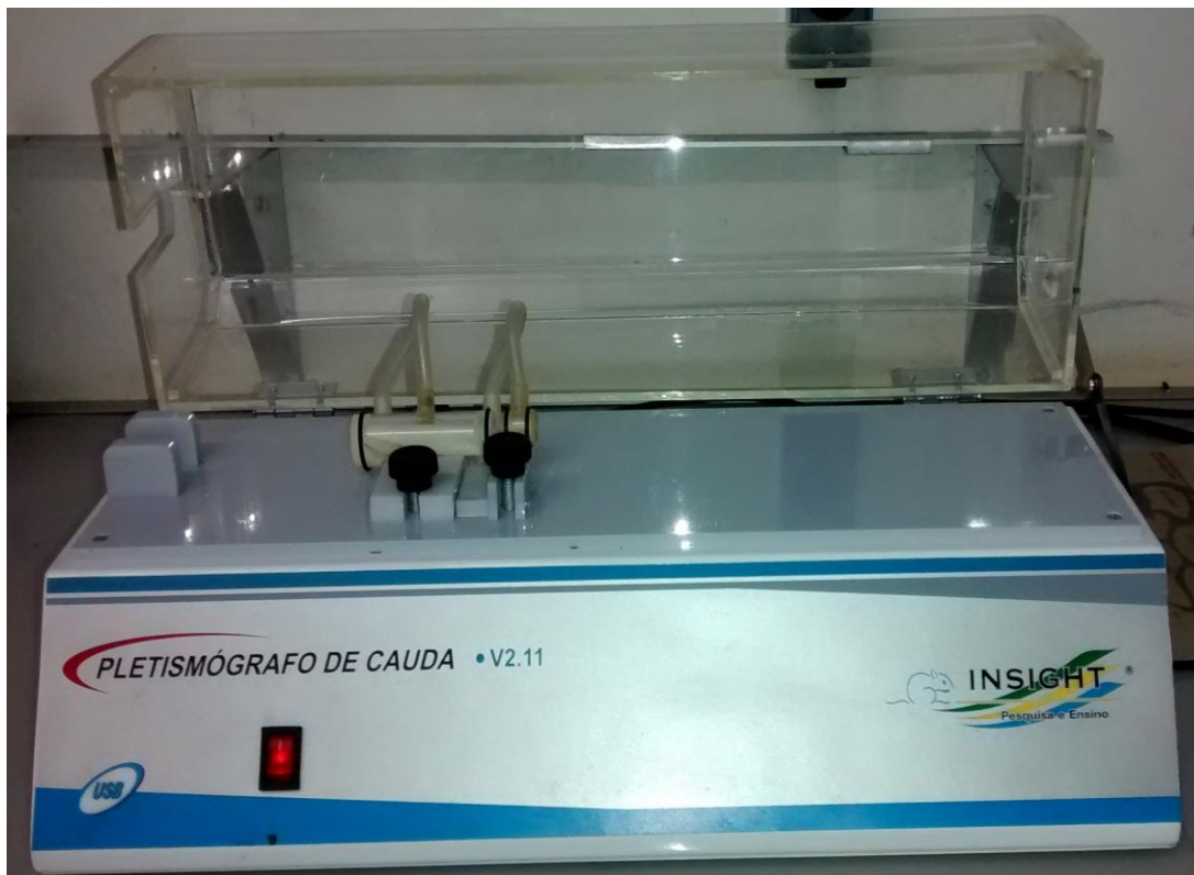
Figura 6. Aparelho para medida indireta de pressão arterial e frequência cardíaca. Pletismógrafo de Cauda – Insight – São Paulo – Brasil. Fonte: Foto realizada pelos autores.
