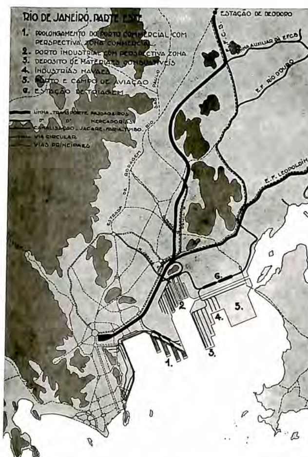
Proposta do urbanista francês Alfred Donat Agache para o bairro industrial da Baixada Fluminense, que abrangeria a área de Manguinhos e as ilhas vizinhas (Sapucaia, Bom Jesus e Pinheiro), ocupando um total de 6,5 km 2 , com obras de aterros, retificação de rios e demolição de morros. O projeto previa, ainda, a instalação de portos industriais navais e um campo de aviação. A instalação do Aero-Clube de Manguinhos, na década seguinte, não foi na mesma área proposta, mas certamente foi influenciada por esse planejamento urbano.
