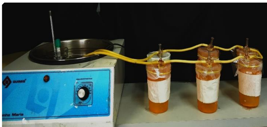
Figura 7. Sistema de alimentação artificial por membrana usado para a infecção experimental dos mosquitos.
