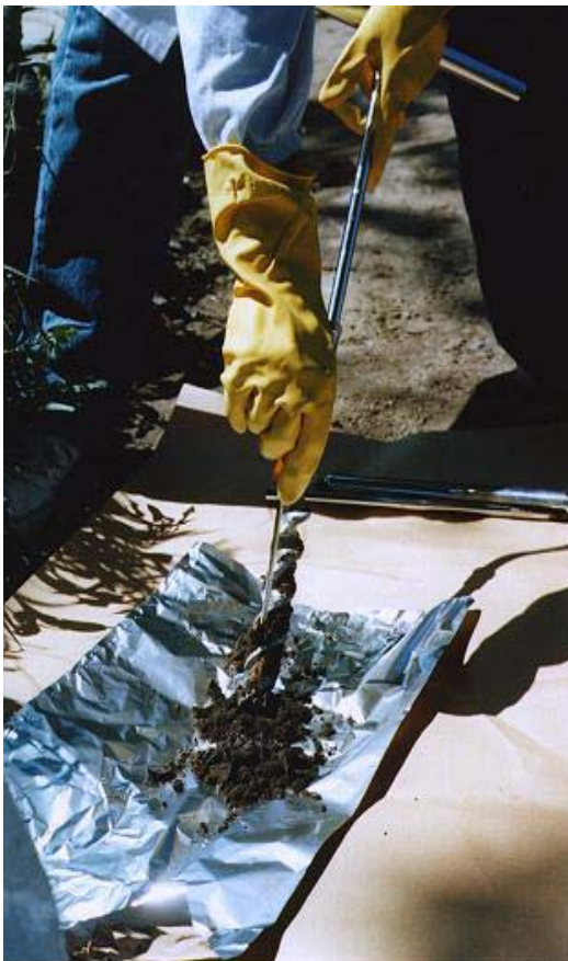
Figura 4.7 : Retirada de amostra de solo do trado
