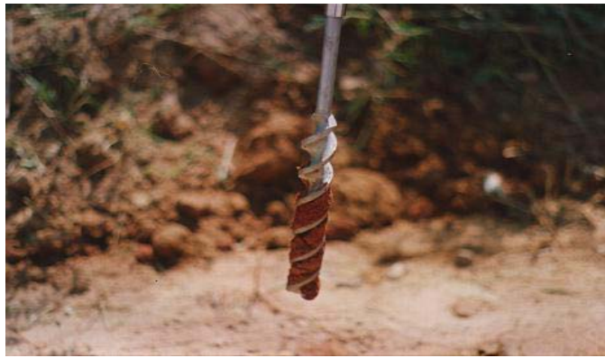
Figura 4.6 : Trado tipo parafuso com amostra de solo aderida
