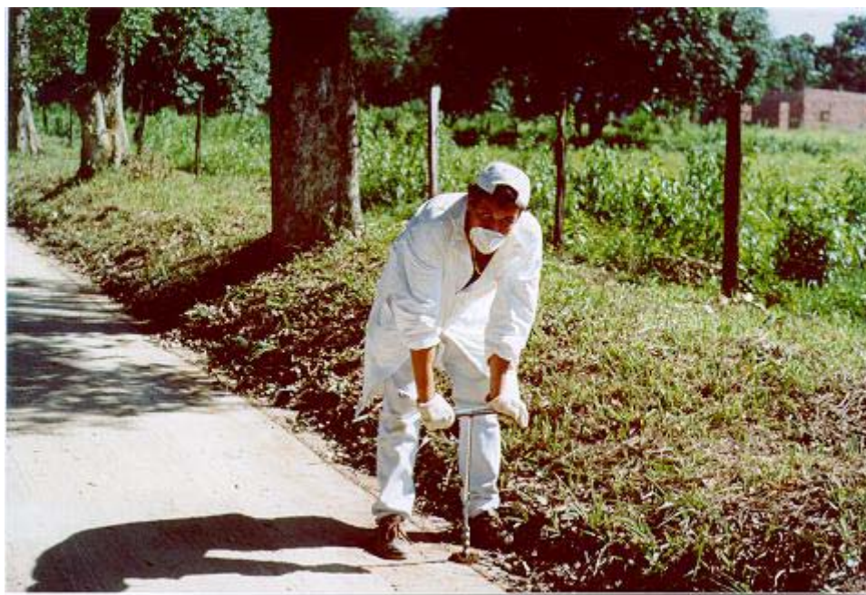
Figura 4.5 : Coleta de amostra de solo na Estrada Camboaba com trado tipo parafuso
