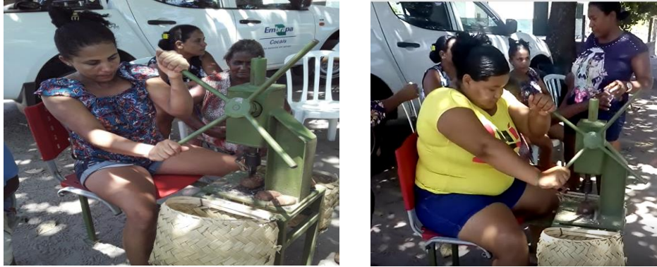
Fotografia 17. Quebradeira em operação: ruptura inicial
