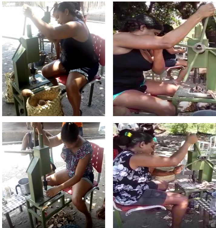
Fotografia 18. Quebradeiras em operação: extração das amêndoas
