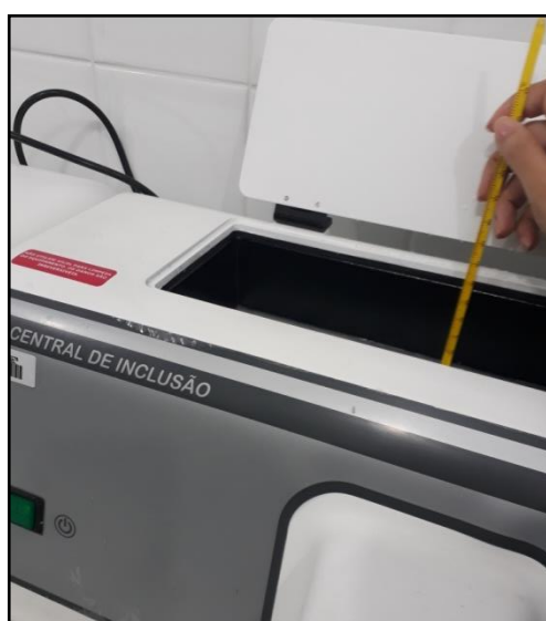
Figura 12. Impregnação em parafina utilizando o compartimento aquecido da central de inclusão e realização de aferição periódica da temperatura com termômetro de mercúrio para controle da faixa térmica. Fonte: Autor
