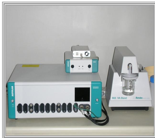
**Figura 10:** Polarógrafo Metrohm PGASTAT
