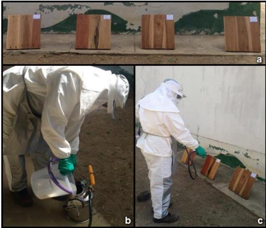
Figura 3.11 – Representação da borrifação de painéis para bioensaio de parede: A - painéis de madeira sem pintura; B - abastecimento da bomba com inseticida e C - borrifação dos painéis.
