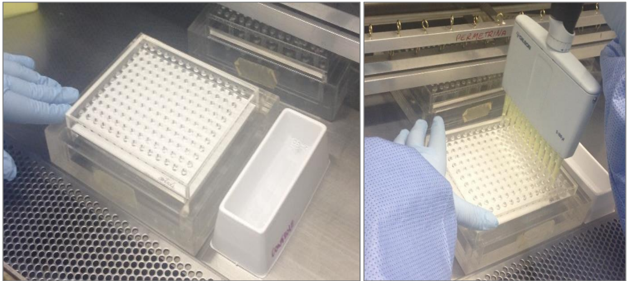
Figura 3.16 – Procedimento de impregnação de papel com inseticida: A – suporte em acrílico; B – impregnação com pipeta multicanal de deltametrina 0,05%. Realizado no LAFICAVE- FIOCRUZ.
