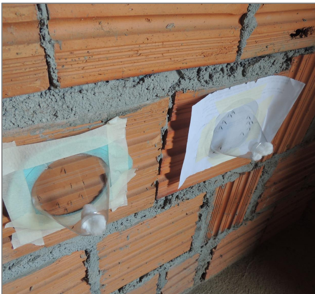
Figura 3.15 – Bioensaios de parede diretamente no campo em residência com parede de alvenaria sem reboco – ASR no município de Mazagão – Amapá, Brasil.
