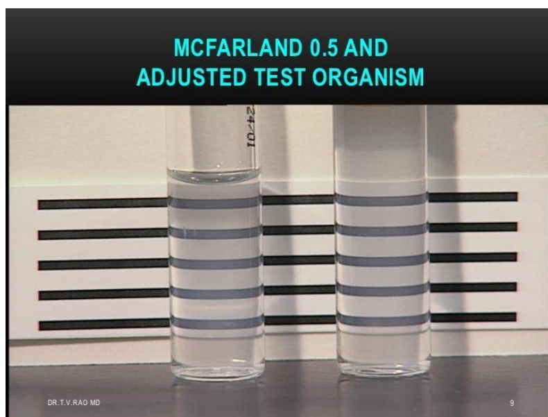
Figura A.1 – Exemplo de utilização do método de McFarland , onde à esquerda se encontra o padrão e, à direita, a amostra.
