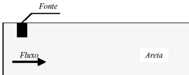
**Figura 13** – Aquífero homogêneo com geometria simples.
