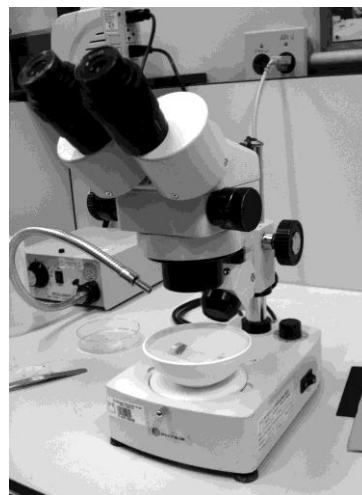
Fig. 8.6. O frasco é mergulhado em água para corrigir a distorção óptica devido a curvatura do vidro.
