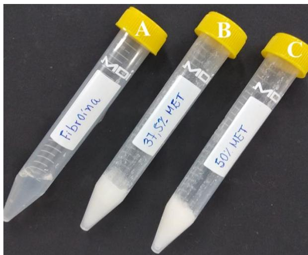
**Figura 6.** Aspecto visual da fibroína em sua forma líquida e após formação de hidrogéis. A: Fibroína após solubilização e posterior centrifugação. B e C: hidrogéis de fibroína sintetizados pela interação com o metanol nas concentrações de 37,5% e 50% (v/v).
