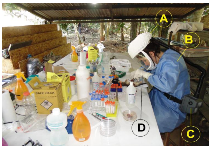
Figura 17. Utilização de equipamentos de proteção individual (EPI) nível 3 de biossegurança utilizados no manuseio e nas necropsias dos pequenos mamíferos, realizados nos laboratórios estabelecidos no campo. (A) Máscara de pressão positiva; (B) Jaleco impermeável; (C) Filtro P3 de ar motorizado; e (D) Luvas de látex para procedimento. Imagens: Charle F. Crisóstomo.
