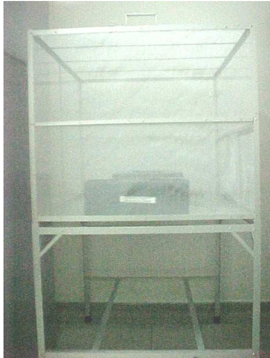
Figura 12 - Gaiola de alumínio e tela de nylon (100 x 80 x 70 cm) utilizada nos bioensaios em laboratório.
