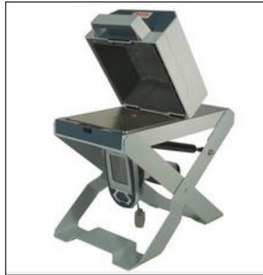
Figura 11: Equipamento de FRX utilizado nas análises de embalagens desse estudo.
