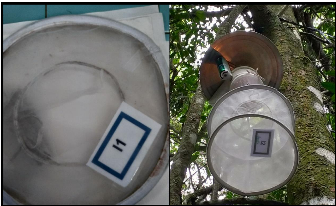
Figura 6 - Coletor da armadilha CDC com placa de identificação (esquerda) e Armadilha do tipo CDC instalada com placa de identificação (direita).
