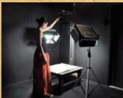
2. O suporte da máquina é movido para ajustar a distância focal.
