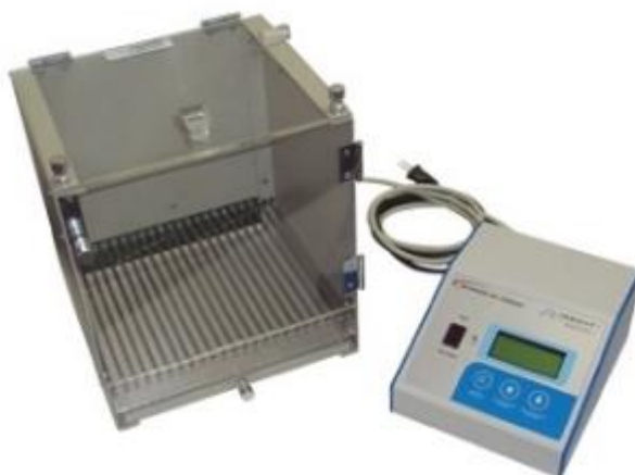
Figura 6 Equipamento utilizado no ensaio de freezing. A caixa consiste de uma plataforma de 2,5 cm de altura x 7,0 cm de largura x 25,0 cm de comprimento, localizada no lado direito de uma caixa de acrílico de 50 x 25 x 25 cm. O piso da caixa é formado por uma grade com uma série de barras paralelas de aço inoxidável (0,1 cm de diâmetro) espaçadas a cada 1,0 cm.
