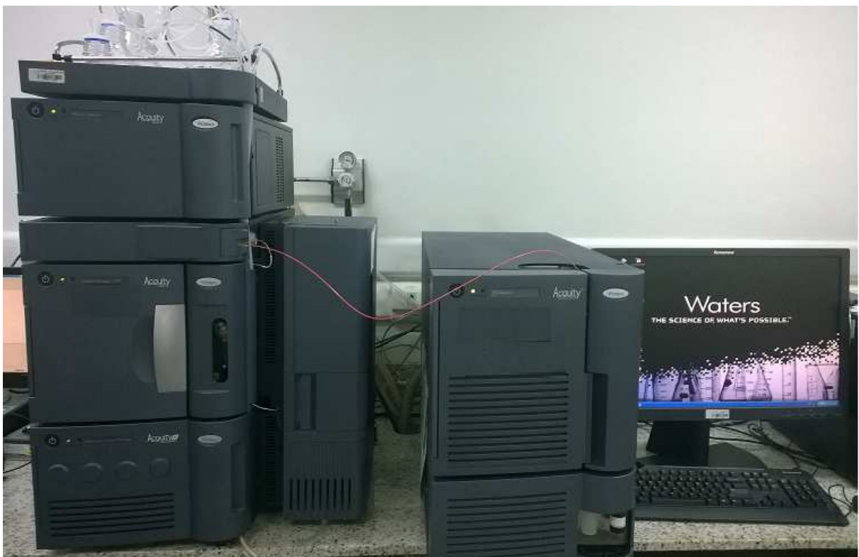
Figura 16 - Cromatógrafo Líquido de Ultra Eficiência da Waters acoplado ao espectrômetro de massas (Acquity Ultra Performance LC).
