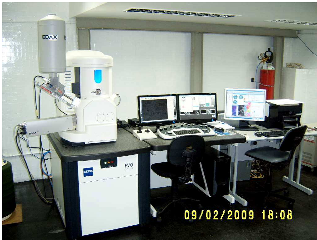
Figura 4.4: Fotografia do microscópio eletrônico digital de varredura EVO MA10 do LMME da EEIMVR/PUVR/UFF.
