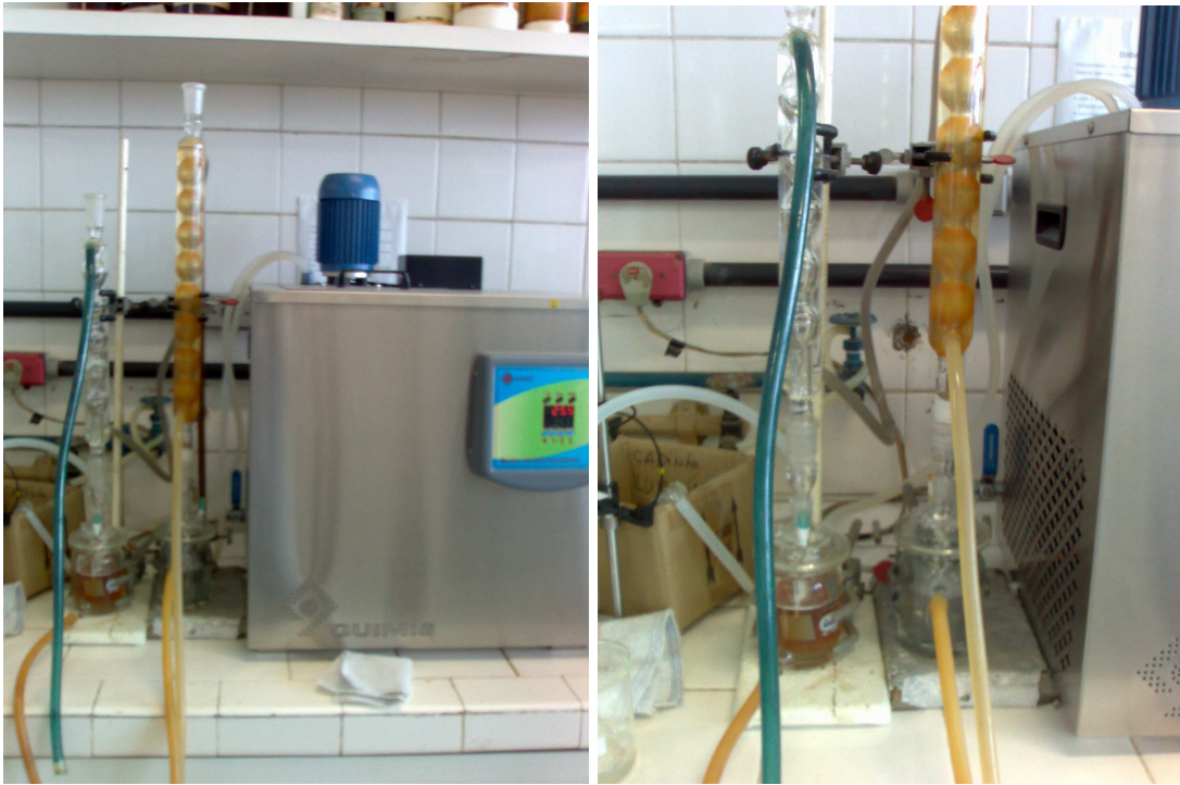
Figura 4.3: Sistema montado para realização dos ensaios de perda de massa com variação de temperatura. (a) Vista frontal; (b) Realização de dois ensaios ao mesmo tempo, inibidor e branco.
