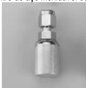
Figura 13 – Fotografia de um filtro de aço inoxidável com elemento filtrante para HPLC.
