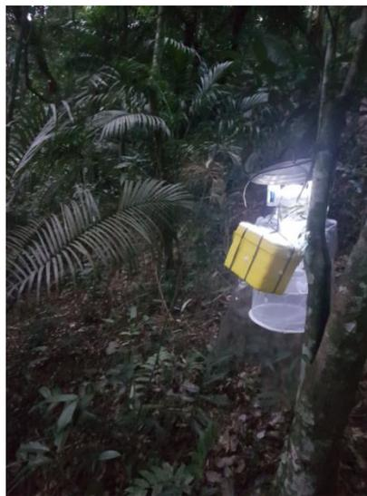
FIGURA 4.2.3 ARMADILHA DO TIPO CDC LUMINOSA COM DETALHE DO ISOPOR (AMARELO) ACOPLADO EM SUA LATERAL CONTENDO GELO SECO
