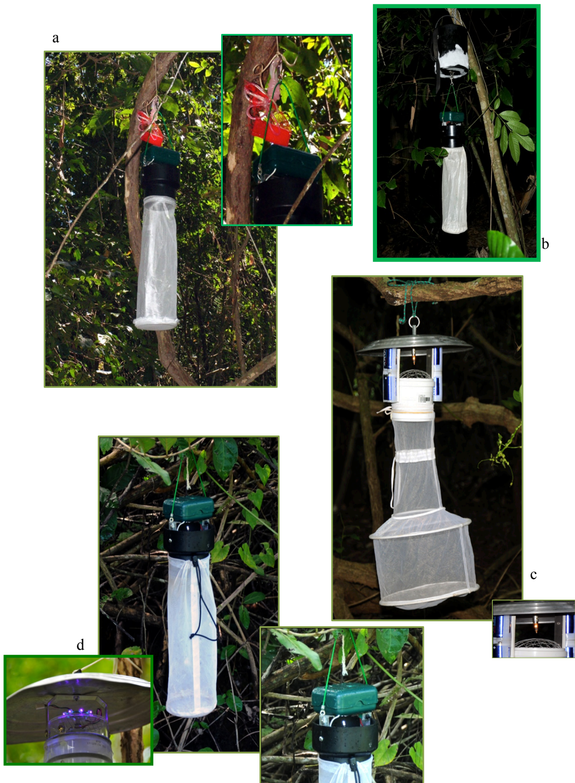
Figura 7: Armadilhas tipo CDC utilizadas para captura de mosquitos no Pantanal Matogrossense: a) CDC com atrativo humano (Lure – diurna e noturna); b) CDC com gelo seco – CO 2 (diurna); c) CDC com luz incandescente (noturna); d) CDC com LED (noturna).
