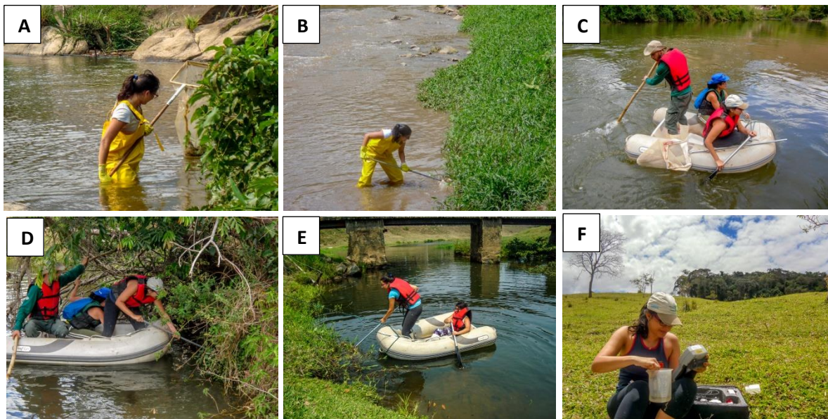
Figura 3. (A- B) Coleta marginal em trechos de pequeno porte; (C) Atravessando trecho não-vadeável para coletar na outra margem; (D-E) Coleta marginal em trechos de grande porte; (F) Análise físico-química da água em campo.
