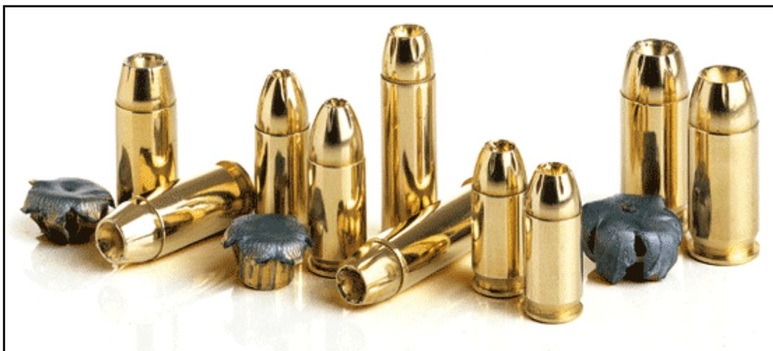
**Figura 4** – Munições encamisadas e projéteis após impacto em gelatina balística
