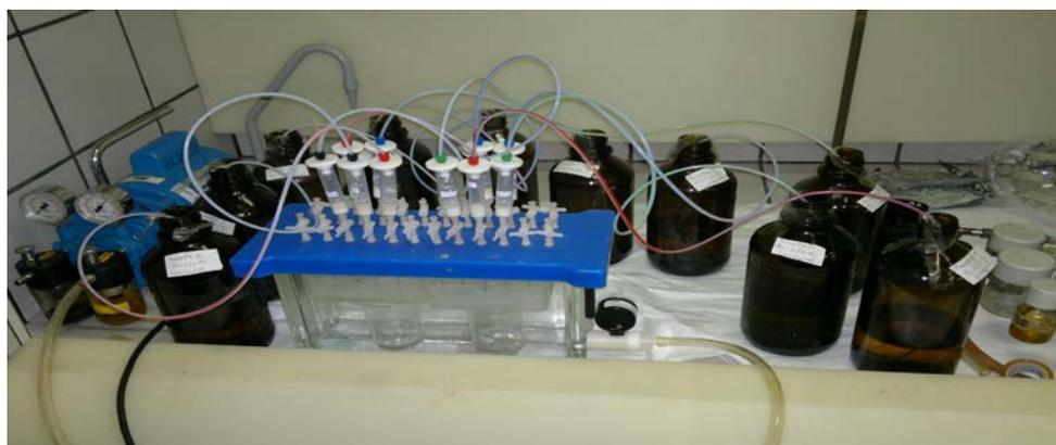
**Figura 2** – Extração em Fase Sólida das amostras com auxílio de sistema Vacuum Manifold.
