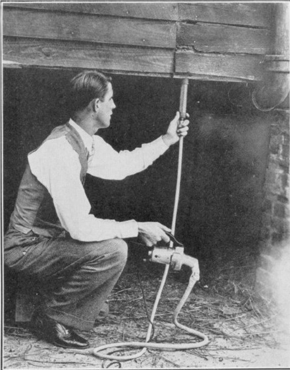
Dispositivo elétrico para sucção de mosquitos. (Griffitths 1931)
