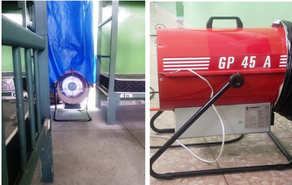
Figura 4 – Equipamento utilizado para o controle térmico de percevejos: visão frontal à esquerda e visão lateral à direita
